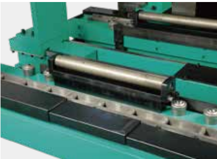
丸パイプ上架ローラー *コラムの場合はローラーは取り外します。
