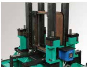
センターバイスでコラムを固定。仕上げ寸法位置までゲージを送り、裏当て金をセットします。
