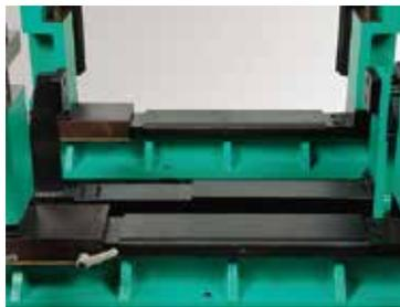
コラムに適したサイズのレールカバー（標準付属品）をセットします。
